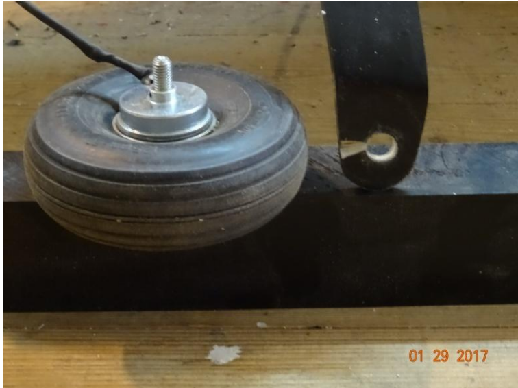
Rad mit aufgesetzter Bremsscheibe (liegt an der Felge an) und durchgeschraubter Radachse 8mm
