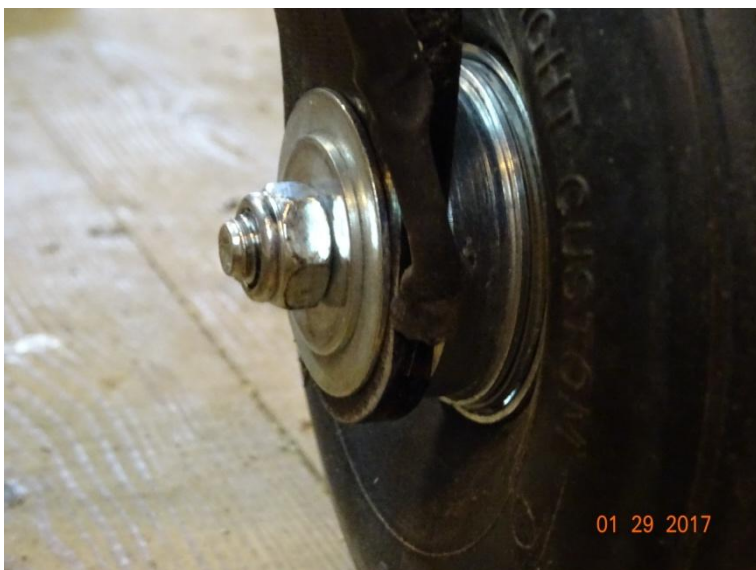
Fertig montiertes Rad mit Bremse, die elektr. Zuleitung ist mit einem Schrumpfschlauch geschützt
